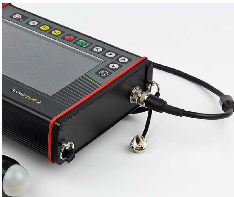
Obraz prawidłowo przykręconego złącza głowicy
