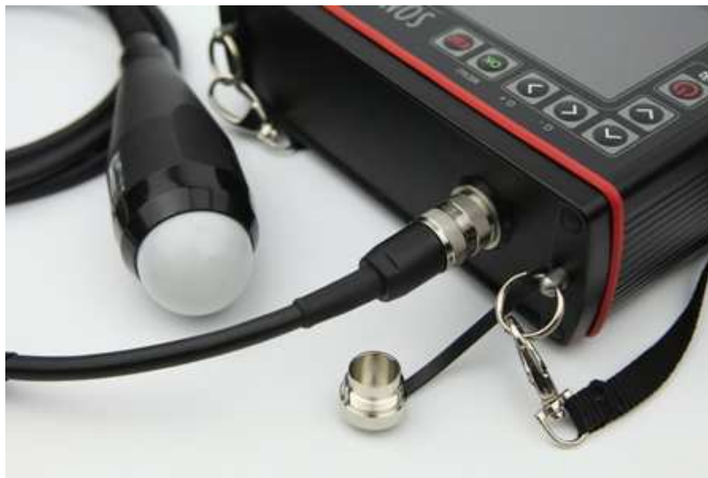
Prawidłowo podpięta sonda do urządzenia
