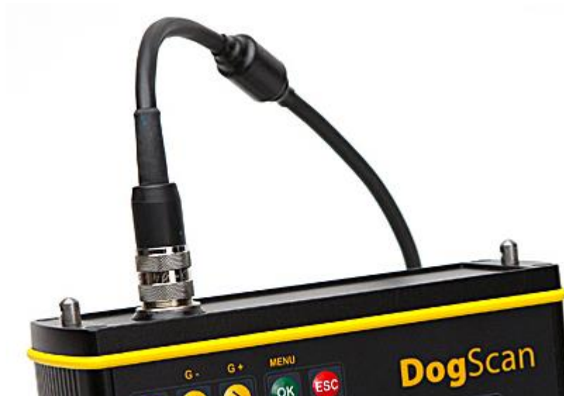
Prawidłowo podpięta sonda do urządzenia
