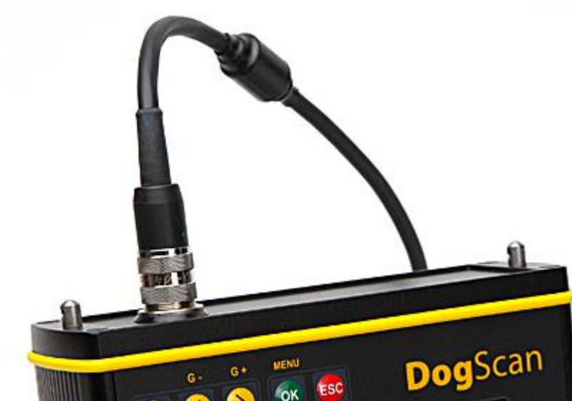
Prawidłowo podpięta sonda do urządzenia
