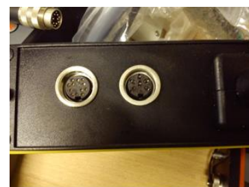
Fot. 2. Wersja z goglami. Gniazdo 5pin transmisji do PC i 12 pin podłączenie gogli
