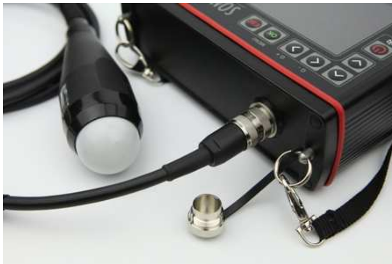
Prawidłowo podpięta sonda do urządzenia
