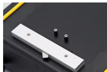
Fot. 3. Zaczip i styki do akumulatora
